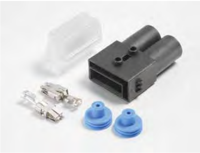
Säkringshållare för MAXI-säkringar Vätsketät hållare med kabelskor och gummi- genomföringar för ingående kabel. För säkring max. 80A. Artikel nr. Benämning P 279 6850 0402 För kabel 4mm² P 279 6850 0602 För kabel 6-10mm² P 279 6850 1602 För kabel 16mm²
