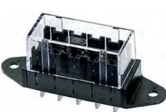
Säkringsdosa 5-polig 5-polig dosa med lock. Lodrät flatstift- eller krets-kortsanslutning. Artikel nr. Benämning 8JD 005 993 001 Med flatstift (max.30A) 8JD 005 993 021 För krets-kort (Max.15A)
