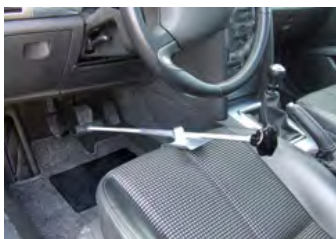
Fig. 22: Montering av bromsspännare
